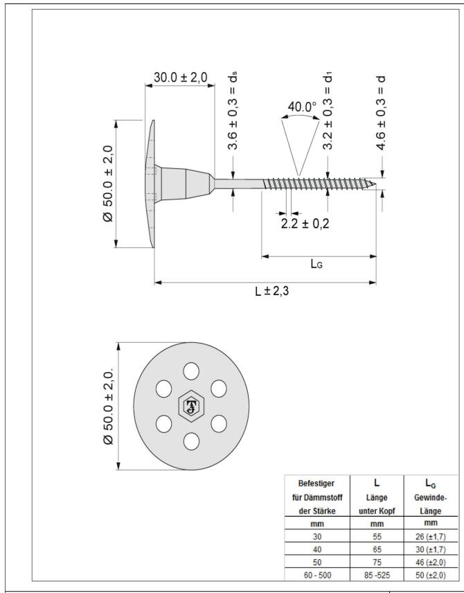
FT-Dämmputzschrauben DPS zur Befestigung von Wärmedämm-Verbundsystemen
